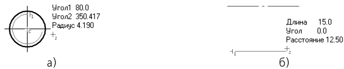
Рис. 8.5. Отображение параметров объектов рядом с курсором: а) при построении дуги по трем точкам, б) при построении отрезка, параллельного данному
