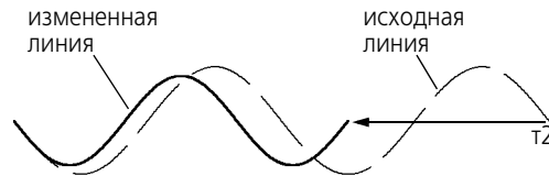
Рис. 28.51. Перемещение характерной точки t_2 при активных переключателях Длина волны и Значение амплитуды в %
